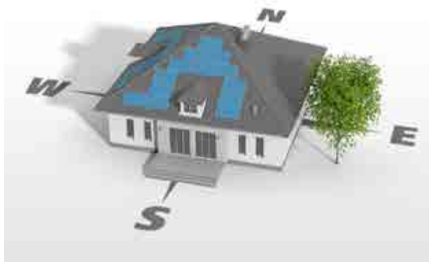
Wariant 2: Niesymetryczna instalacja na dwóch połaciach
