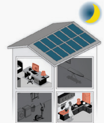
W nocy: Główne urządzenia są zasilane z baterii
