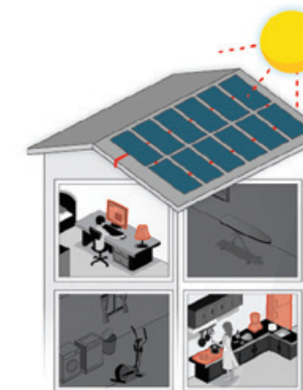
W dzień: Główne urządzenia odbiorcze są zasilane w pierwszym rzędzie z instalacji fotowoltaicznej, a następnie z baterii. W razie potrzeby baterię można naładować z instalacji fotowoltaicznej
